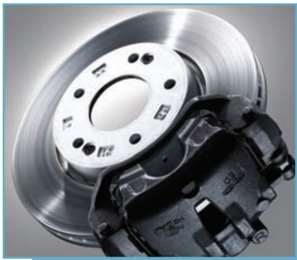
| Freno a disco. La presión provoca que el estribo hidráulico oprima las plaquetas de freno sobre el disco.
