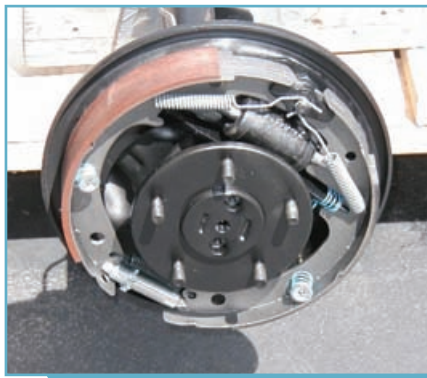
| Freno de tambor. La presión provoca la separación de las zapatas que entran en contacto con la campana o tambor.
