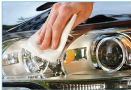
Limpieza | Si los faros u ópticas están sucios se reduce la distancia de alumbrado.
