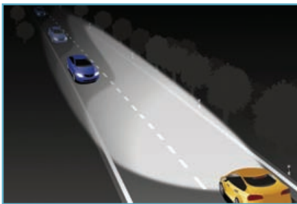
Altura | Si el reglaje es alto, deslumbrará a otros conductores. Si es bajo perderá visibilidad.
